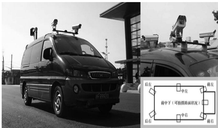
图 3-6 交通系统综合监测和拍摄系统
